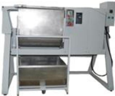
**Машина тестомесильная ТМ-150** – предназначена для вымешивания различных кондитерских масс (сахарное, пряничное тесто, тесто для баранок, сухек). Выгрузка массы осуществляется в заранее подготовленную емкость путем поворота смесителя.
