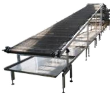
**Конвейер охлаждения ярусного типа ЯРУС** предназначен для охлаждения кондитерских изделий после выпечки и других технологических процессов. Главными отличительными особенностями данного конвейера охлаждения являются производительность, компактность и масштабируемость. Основное применение в линиях производства пряника на этапе охлаждения продукта после тиражирования (глазирования сахарным сиропом).
